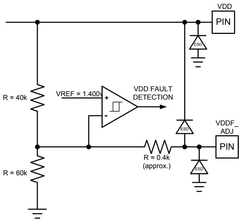
Figure 18: VDD<sub>FLT\_ADJ</sub>
