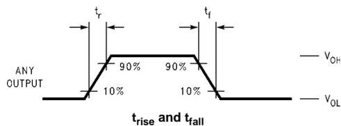
**FIGURE 2. Waveforms**
