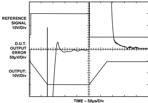
Figure 22. 18-Bit Settling
