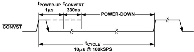
Figure 10. Automatic Power-Down
