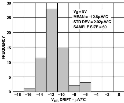
TPC 2.  $V_{OS}$  Drift Over  $-40^{\circ}\text{C}$  to  $+85^{\circ}\text{C}$
