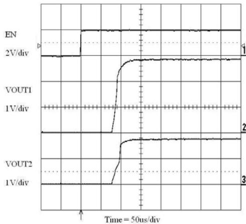
Figure 22. Enable Turn-on
