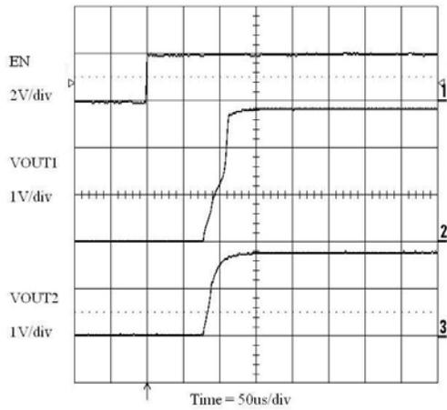
Figure 20. Enable Turn-on
