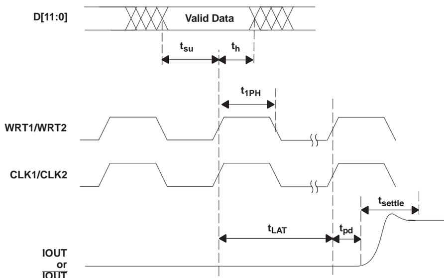
Figure 18. Dual-Bus-Mode Operation
