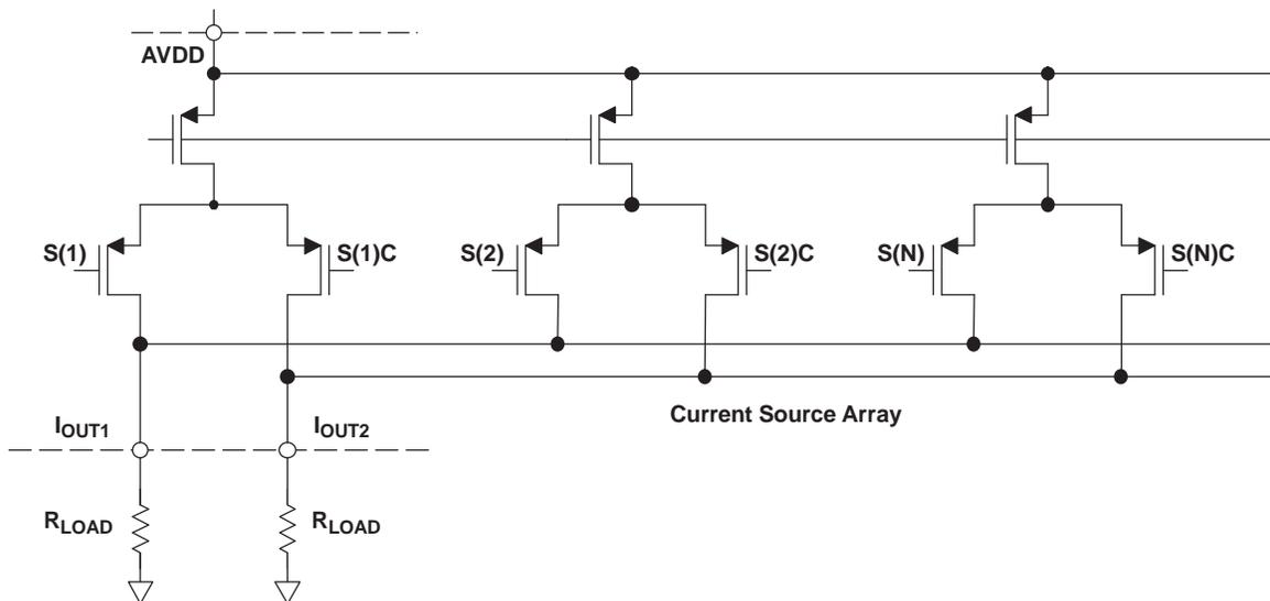
**Figure 20. Analog Outputs**
