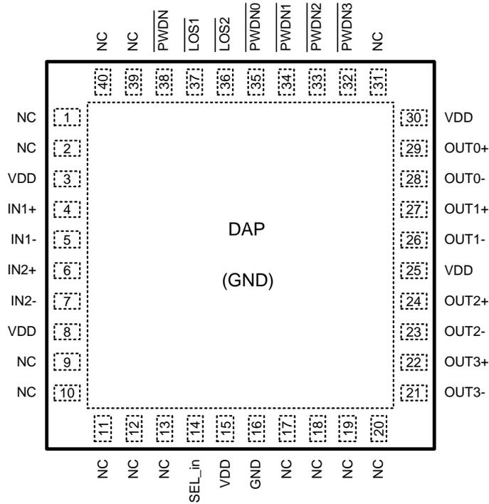
**Figure 1. DS10BR254 Pin Diagram**
