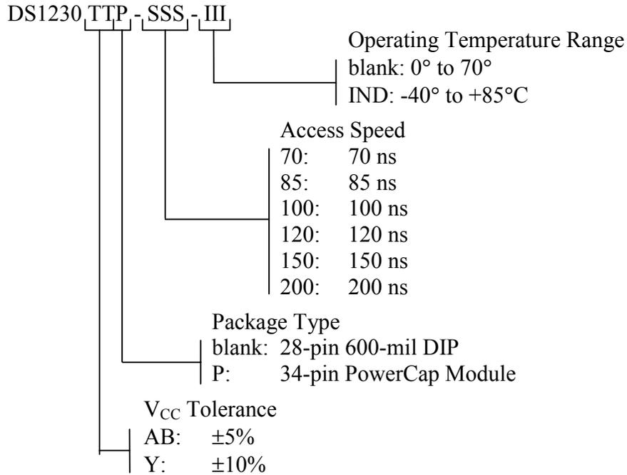
**DS1230Y/AB NONVOLATILE SRAM, 28-PIN 740-MIL EXTENDED DIP MODULE**
