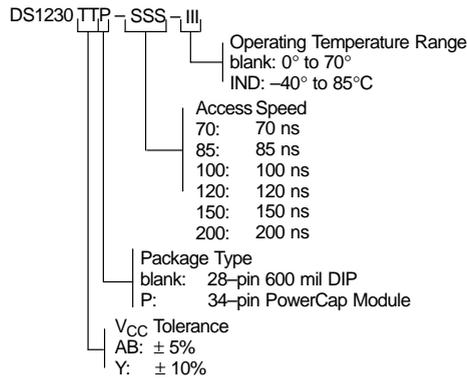
**DS1230Y/AB NONVOLATILE SRAM, 28-PIN 740 MIL EXTENDED DIP MODULE**
