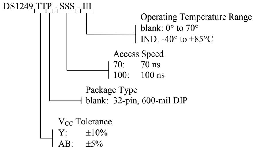
**DS1249Y/AB NONVOLATILE SRAM, 32-PIN, 740-MIL EXTENDED MODULE**
