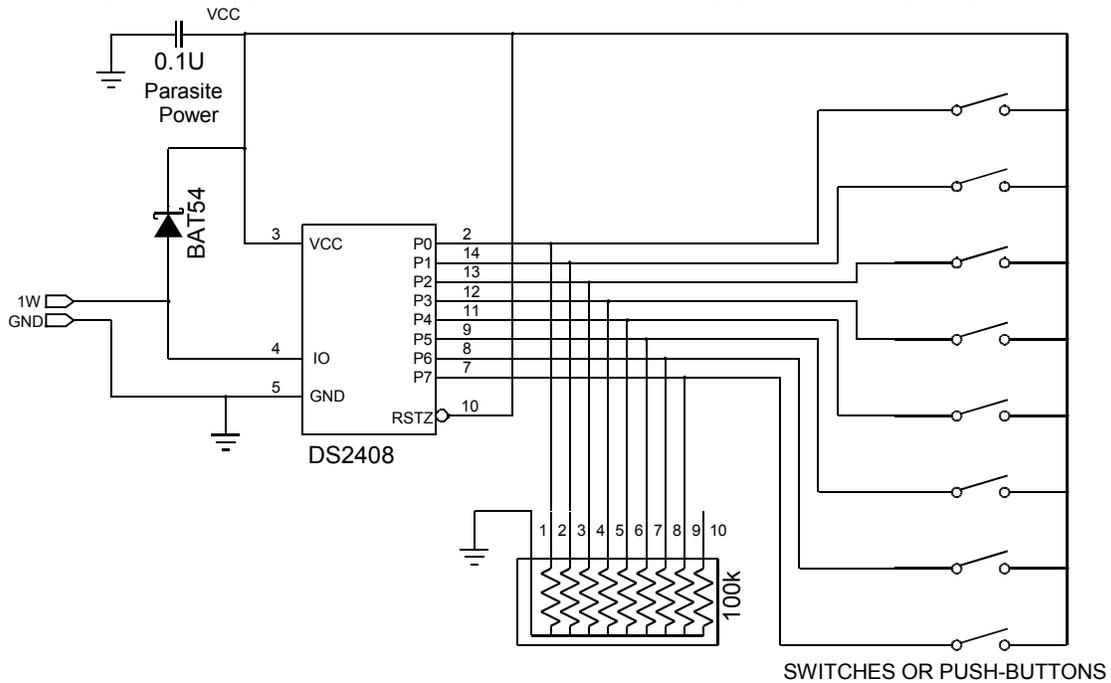
**Figure 22. DS2408 AS MULTIPURPOSE SENSOR/ACTUATOR**
