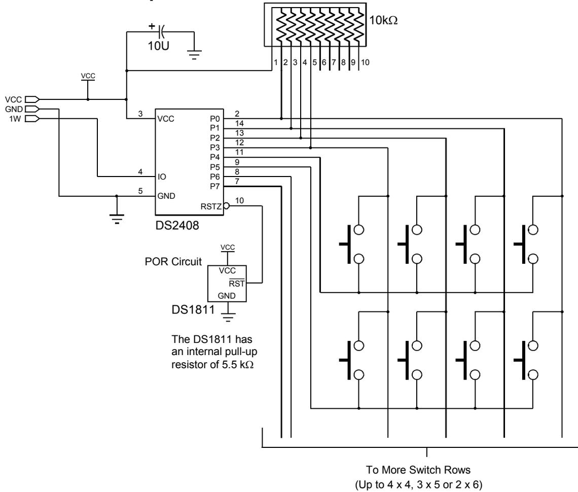
**Figure 21. DS2408 AS PARASITE-POWERED PUSH-BUTTON SENSOR**
