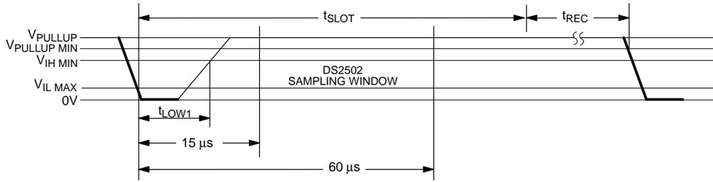
$$60 \mu\text{s} \leq t_{\text{SLOT}} < 120 \mu\text{s}$$
