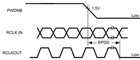
Figure 9. Powerdown Delay
