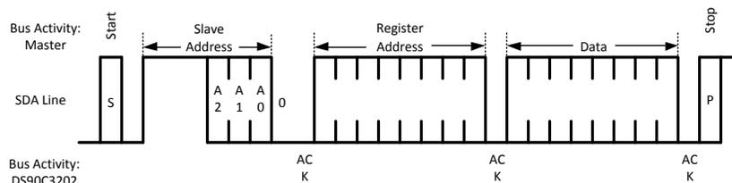
Figure 21. Byte Write
