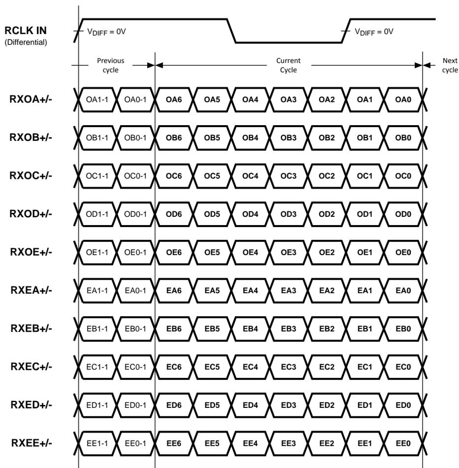
Figure 17. LVDS Input Mapping
