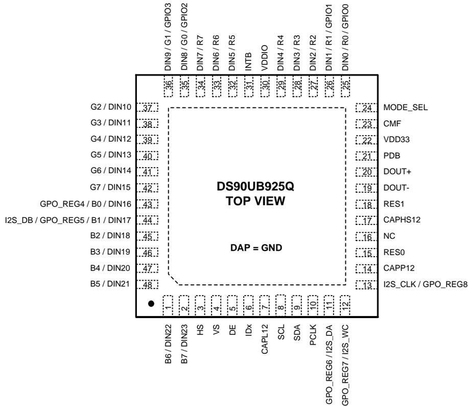
Figure 1. DS90UB925Q — Top View
