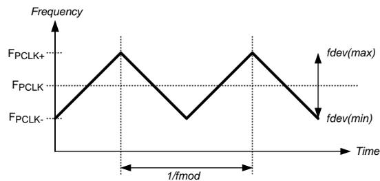
**Figure 17. SSCG Waveform****1.8V or 3.3V VDDIO Operation**
