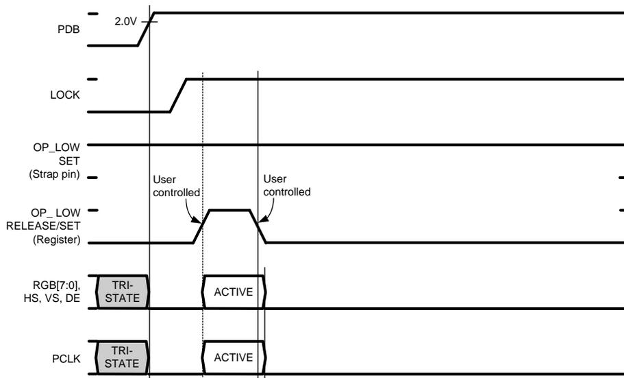
Figure 22. OP\_LOW Manual Set/Reset
