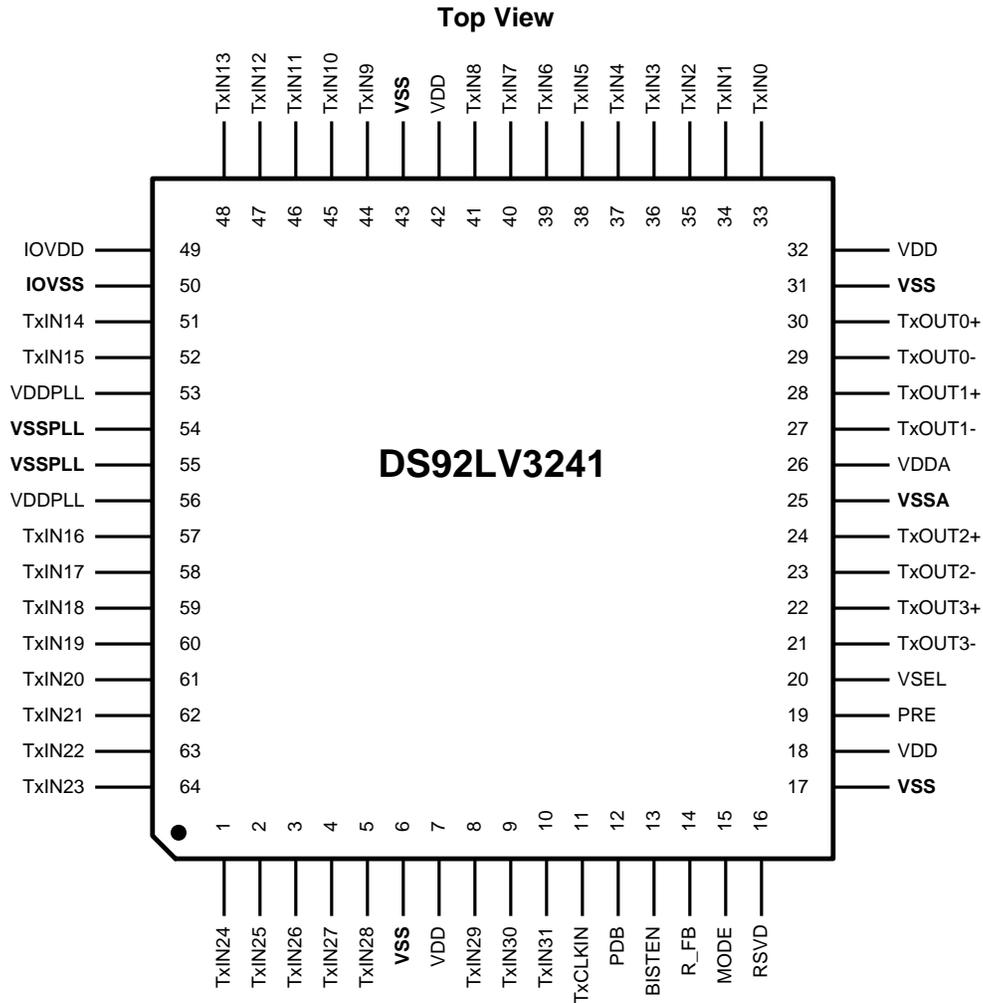
**Figure 3. DS92LV3241 Pin Diagram
