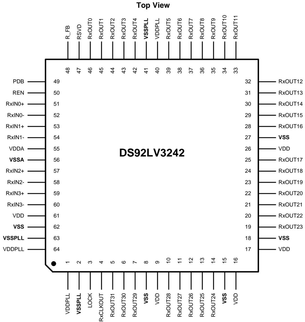
Figure 4. DS92LV3242 Pin Diagram
