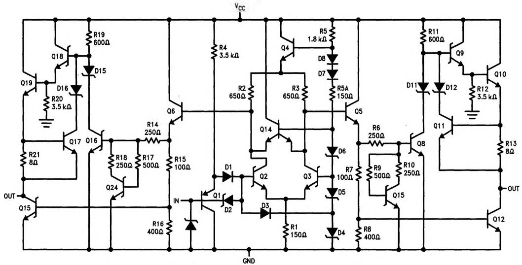
**FIGURE 1. Equivalent Circuit**
