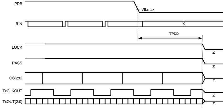
Figure 4. FPD-Link & LVC MOS Powerdown Delay
