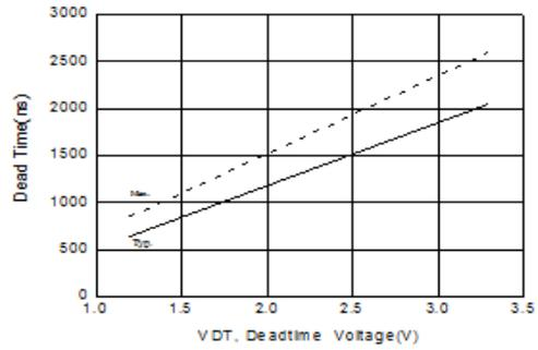
Figure 10. Dead Time vs. V<sub>DT</sub> (V<sub>CC</sub>=V<sub>BS</sub>=15 V, -40°C < T<sub>J</sub> < 125°C)
