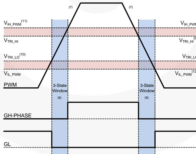
**Figure 28. PWM Threshold Definition**
