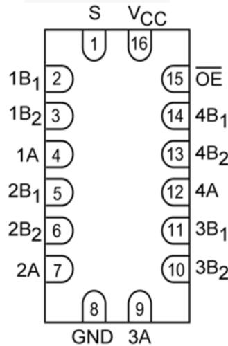
Figure 3. DQFN Pin Assignments
