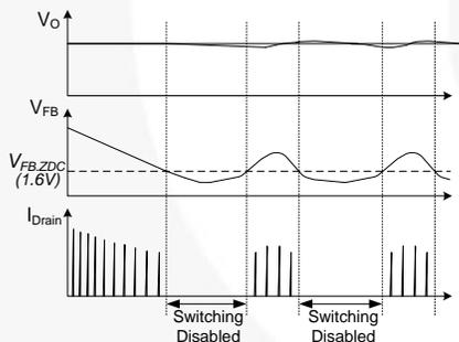
**Figure 27. Burst-Mode Operation**
