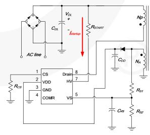
Figure 28. HV Startup Circuit
