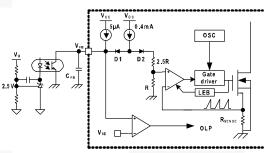
Figure 16. Pulse-Width-Modulation Circuit
