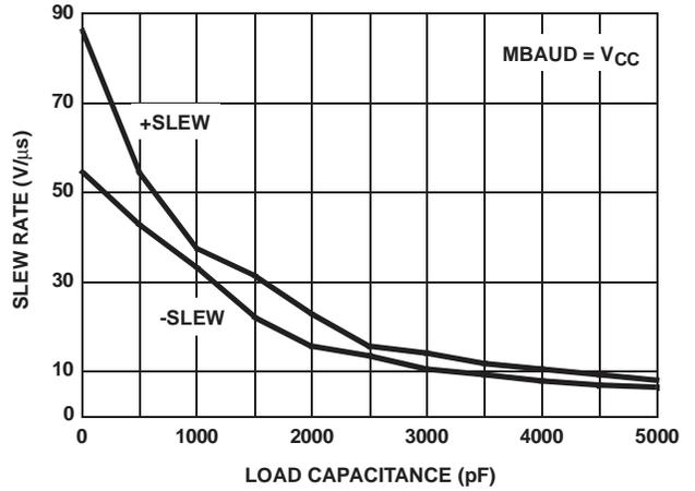
FIGURE 11. HIGH SPEED SLEW RATE vs LOAD CAPACITANCE
