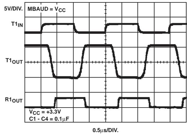
FIGURE 7. LOOPBACK TEST AT 1Mbps ( $C_L = 250\text{pF}$ )
