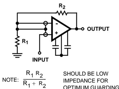
FIGURE 1C. NON-INVERTING AMPLIFIER
