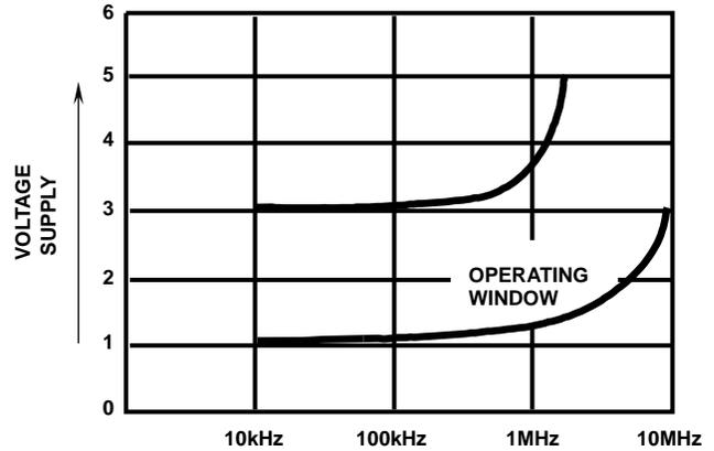
FIGURE 8. WINDOW OF CORRECT OPERATION
