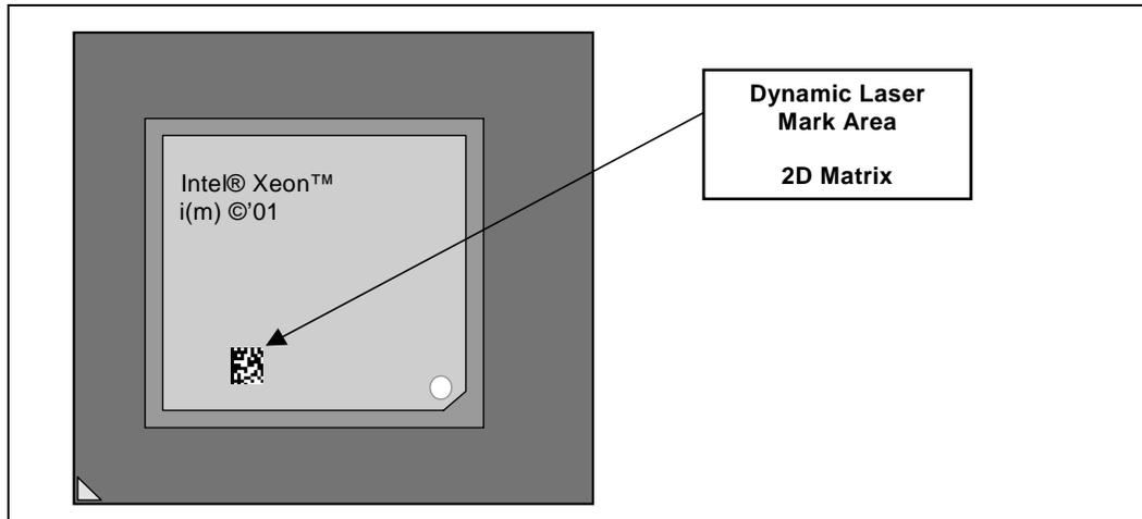
**Figure 30. Processor Bottom-Side Markings**
