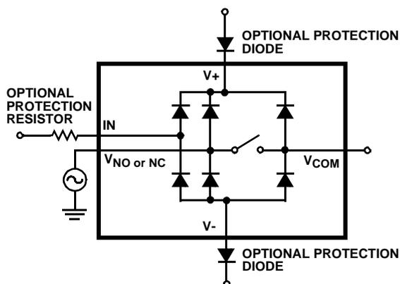
FIGURE 6. OVERVOLTAGE PROTECTION
