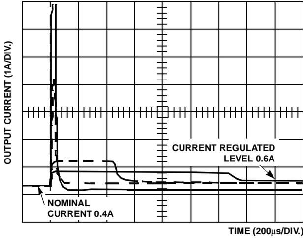
FIGURE 6. OC TO CR SETTLING TIME WAVEFORMS
