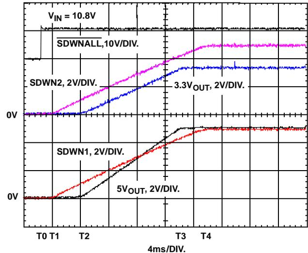
FIGURE 2. SOFT START ON 3.3V AND 5V OUTPUTS
