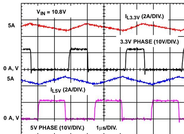
FIGURE 1. OUT OF PHASE OPERATION
