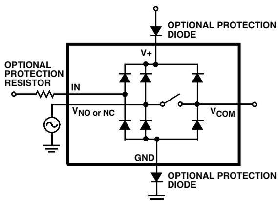
FIGURE 6. OVERVOLTAGE PROTECTION
