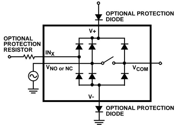
FIGURE 8. OVERVOLTAGE PROTECTION
