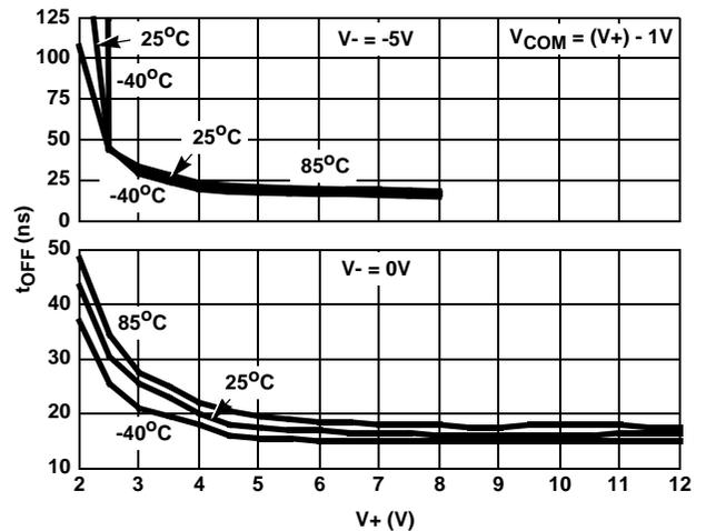
FIGURE 14. TURN - OFF TIME vs SUPPLY VOLTAGE
