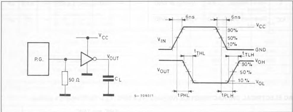
TEST CIRCUIT  $I_{CC}$  (Opr.)
