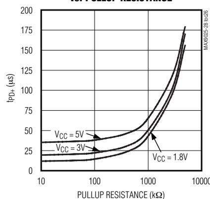
**PROPAGATION DELAY ( $V_{CC} = 5V$ )**
