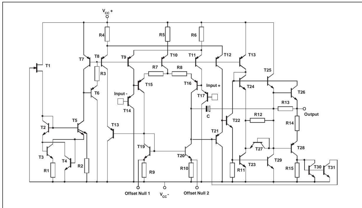
**INPUT OFFSET VOLTAGE NULL CIRCUIT**
