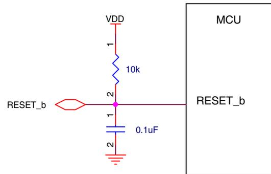
**Figure 36. Reset circuit**
