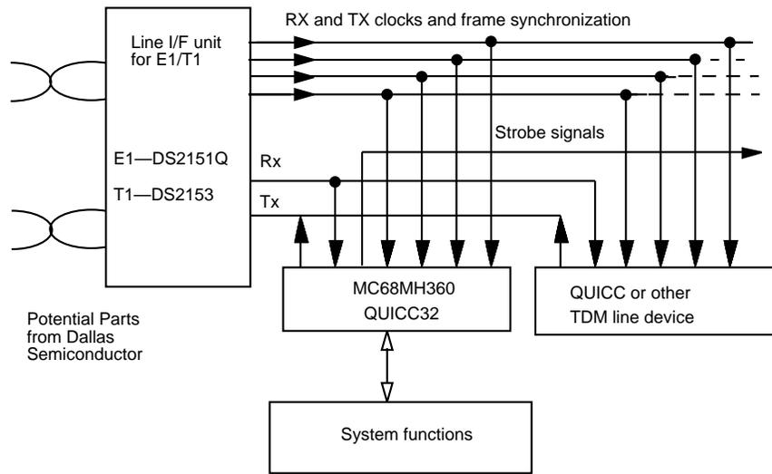
**Figure 1-9. MC68MH360 Connection to a TDM Bus**
