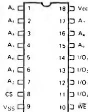
**A<sub>0</sub> ~ A<sub>4</sub>** : Address Inputs
