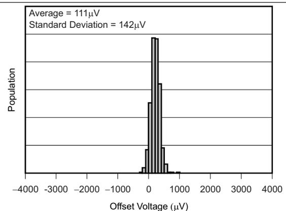
Figure 12. DDA Package Offset Voltage Production Distribution
