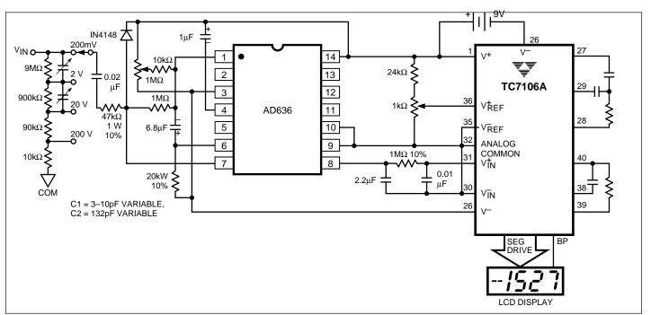
Figure 18. 3 1/2 Digit True RMS AC DMM
