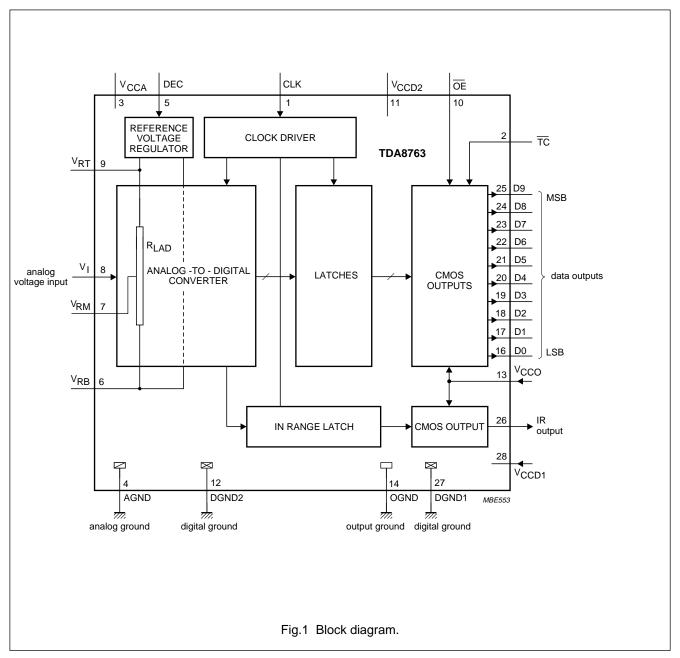
28 VCCD1 27 DGND1 26 IR 25 D9 24 D8 23 D7 22 D6
