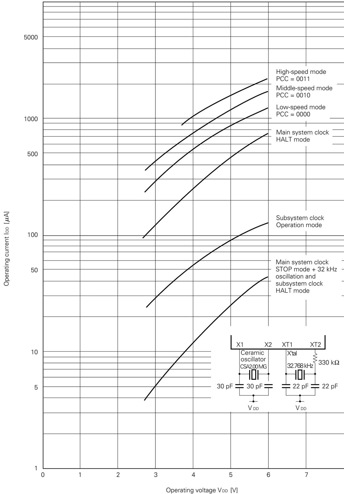
I<sub>DD</sub> vs V<sub>DD</sub> (Ceramic oscillation:1 MHz)
