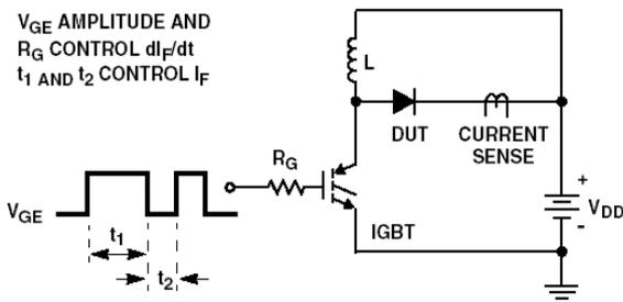
t<sub>rr</sub> TEST CIRCUIT
