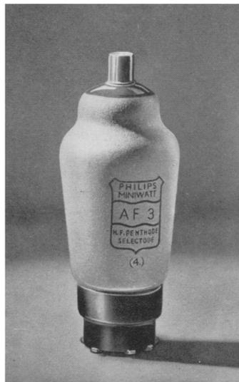
Die normale Steilheit ist dabei 2,1 mA/V und der normale Anodenstrom 7,5 mA. Bei 60 Volt Schirmgitterspannung liegt der Regelbereich zwischen ca. -2 und -35 Volt. Die normale Steilheit beträgt dann 1,5 mA/V und der normale Anodenstrom 4 mA.
