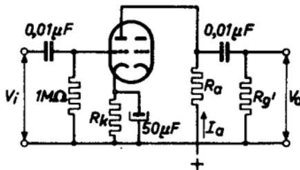
a)  $R_a = 0,047 \text{ M}\Omega$ ;  $R_{g'} = 0,15 \text{ M}\Omega$ ;  $R_k = 1,2 \text{ k}\Omega$
