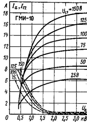
Импульсный модуляторный тетрод для работы в качестве модулятора в импульсных радиопередающих устройствах.
