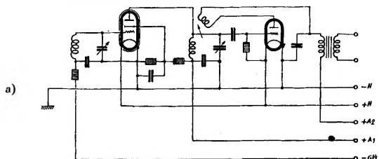
Wie bei allen Schirmgitterhochfrequenzröhren empfiehlt es sich, mit sogenannten Anodensperrkreisschaltungen (a) oder deren Abwandlungen (z. B. b) zu arbeiten.
