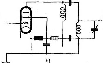
Die Röhre RES 094 ist außen metallisiert. Die Metallisierung ist an einen Kathodenstecker angeschlossen (vgl. Sockelschaltbild). Die Außenmetallisierung spart Abschirmmittel zwischen der Röhre und dem ihr zugeordneten Gitterkreis und bewirkt eine nicht unbeträchtliche Herabsetzung der Steuergitter-Anoden-Kapazität. Eine Abschirmung der einzelnen Abstimmkreise bzw. Stufen gegeneinander wird durch die Außenmetallisierung keinesfalls überflüssig gemacht.
