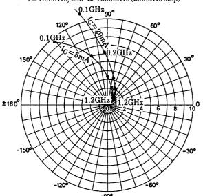
$S22e: V_{CE}\!=\!-10V \\ f\!=\!100MHz, 200 \ \ \mbox{to} \ \ 1200MHz \, (200MHz \, step)$
