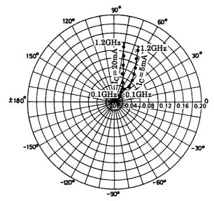
$S21e:V_{CE}\!=\!-10V$   $f\!=\!100MHz,200\,$  to  $1200MHz\,(200MHz\,step)$
